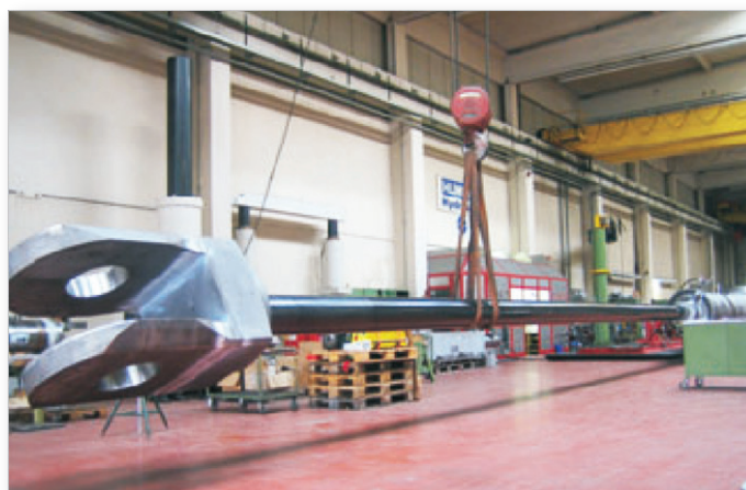
Xy lanh thủy lực cho cổng nạp điện với biên độ dài 17,550 mm
